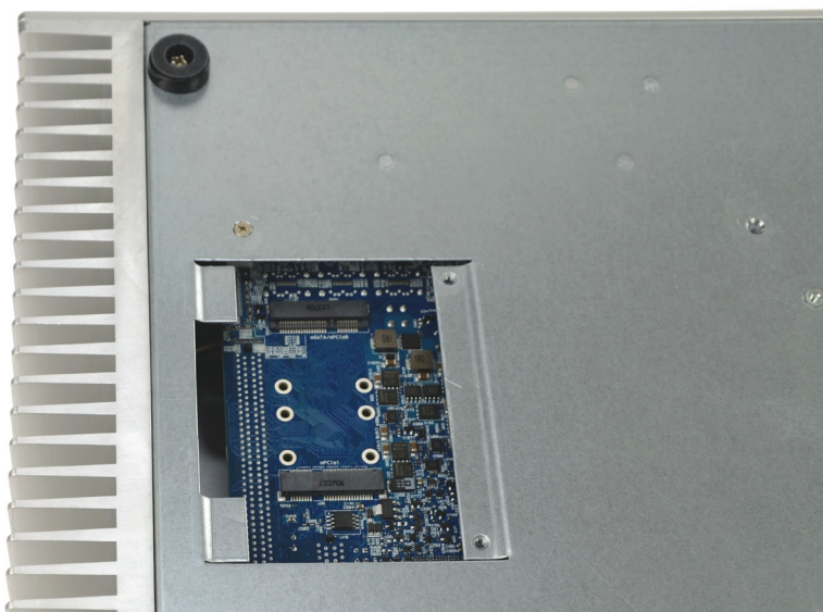
Unterseite Steckplatz für Mini-PCIe Karten
