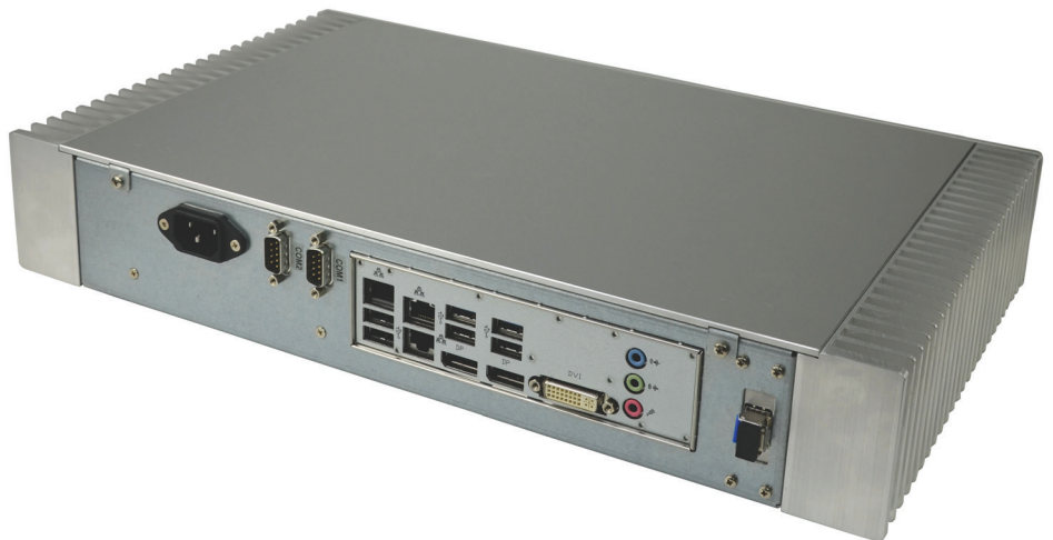
Rückseite mit ATX-Blende, RS232 und Netzanschluß, hier mit zusätzlichem LWL Netzwerk ( Fiber Gecko )
