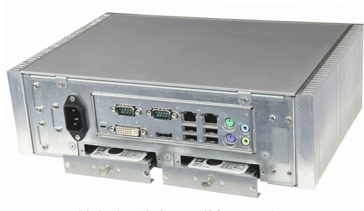
Rückseite mit ATX-Blende, Netzanschluß 85..265V sowie den beiden Festplattensteckplätzen
