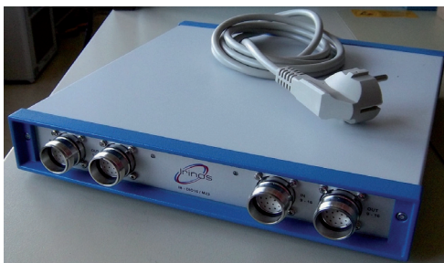
I/O-Box für I/O-Bus mit integriertem Netzteil
