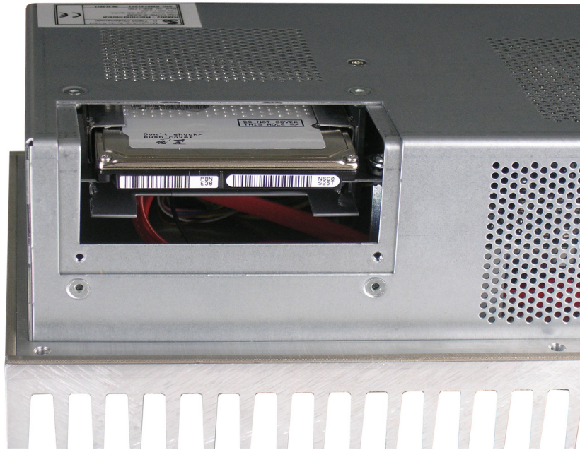
Sicht auf Festplattensteckplätze, obere Platte bestückt
